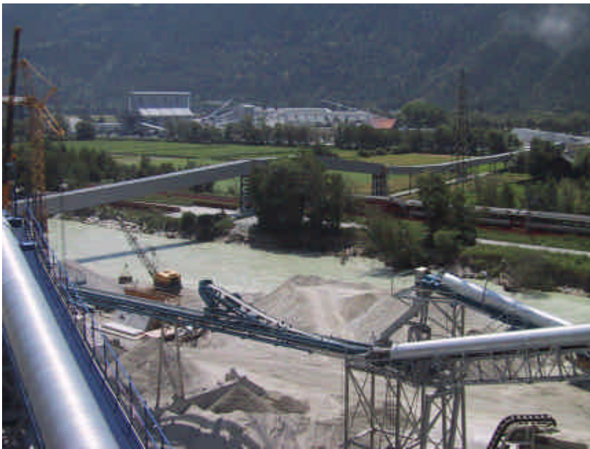
Transport des matériaux au moyen de tapis roulants
